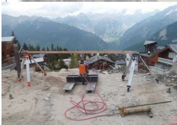
Essai de traction sur micropieu
